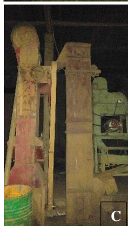
A. visite de l'usine de stockage et de transformation des baies de la COOPAFERLOS ; B. sacs de café stockés depuis environ 2 ans par la coopérative en attendant de potentiels acheteurs ; C et D. machines de dépulpage/décorticage des baies de café.
