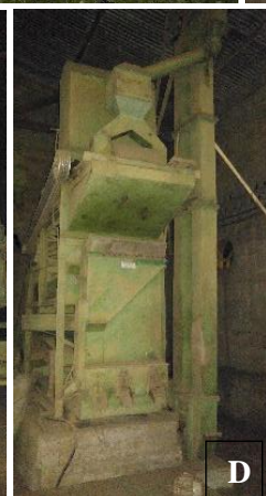
A. visite de l'usine de stockage et de transformation des baies de la COOPAFERLOS ; B. sacs de café stockés depuis environ 2 ans par la coopérative en attendant de potentiels acheteurs ; C et D. machines de dépulpage/décorticage des baies de café.
