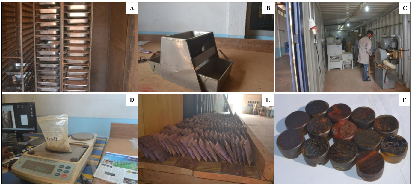
Figure 32 : Prétraitement et conditionnement des échantillons pour analyses. A : colonne de séchage des échantillons ; B : appareil de quartage des échantillons ; C : atelier de broyage et pulvérisation des échantillons ; D : pesage des poudres après pulvérisation ; E : poudres conditionnées pour expédition au laboratoire d'analyses géochimiques et minéralogiques ; F : blocs polis pour observations au microscope métallographique.
