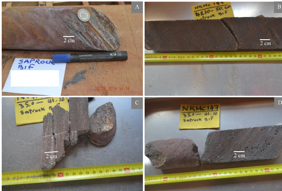
Figure 42 : Caractères macroscopiques de la saprolite grossière de BIF. A et B , carottes de saprolite grossière de BIF à lits plissés ; C , fines diaclases recoupant les lits de la saprolite grossière ; D , pores dans un bloc de saprolite grossière.
