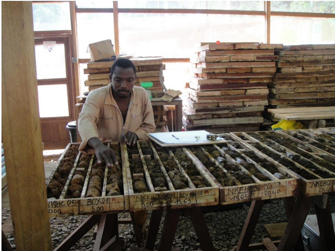
Figure 29 : Description des carottes de sondage dans l’atelier des logging ou “Core Yard” sur le site de Nkout.
