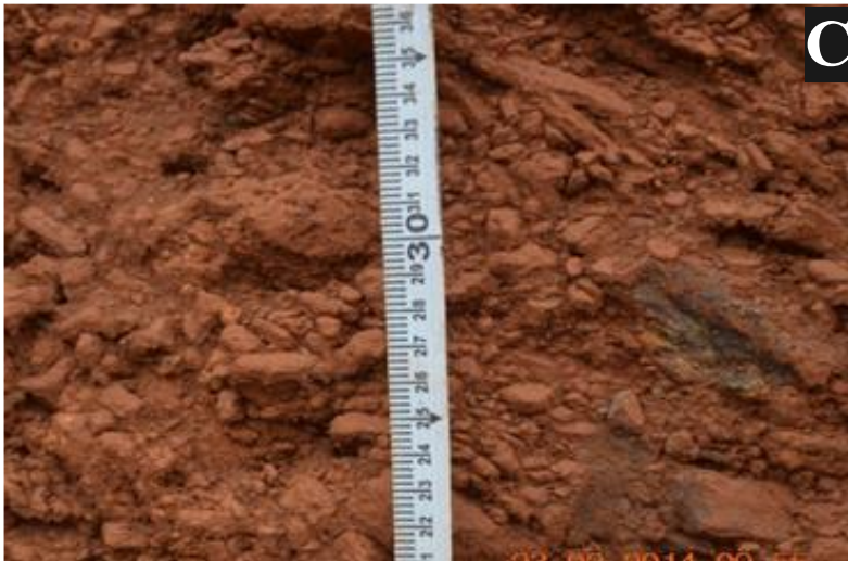
Figure 49: Ensemble ferrugineux. A , Vue de la cuirasse ferrugineuse conglomératique ; B , diffractogramme de la cuirasse ferrugineuse ; C , Vue de l'horizon glébulaire ; D , diffractogramme de l'horizon glébulaire.
