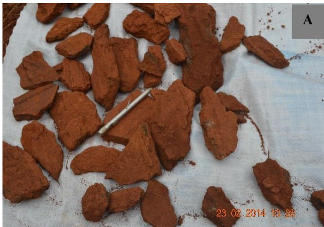
Figure 50 : Plaquettes ferrugineuses lithomorphes : A , aspect macroscopique ; B , diffractogramme et composition minéralogique semi-quantitative.
