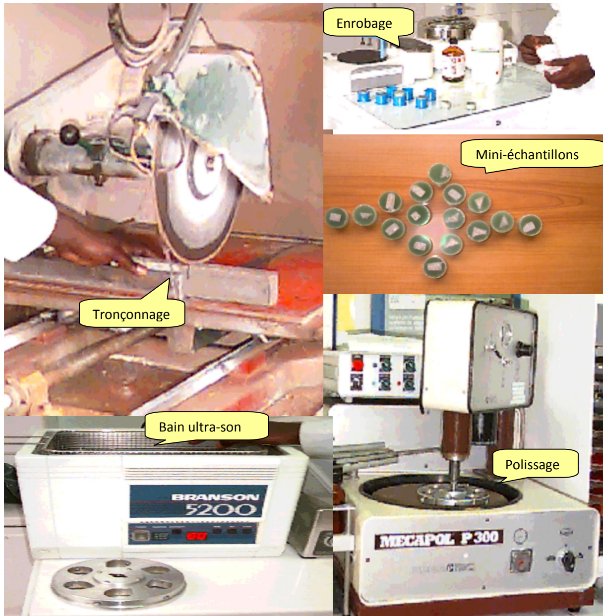
Figure 4.1: Machines et accessoires pour préparation d'éprouvettes
