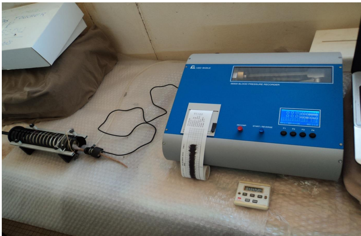
Photo 6: Dispositif de mesure de la Pression artérielle et de la fréquence cardiaque (Blood Pressure Recorder 58500) in vivo
