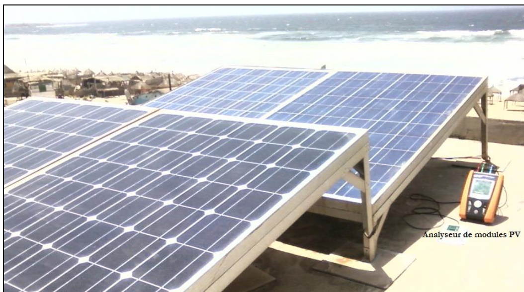
Figure III- 26. Modules exposés sous environnement marin.
