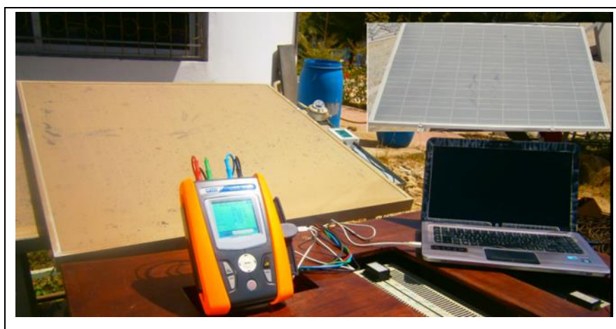
Figure IV- 2. Modules exposés sous ensoleillement après un an sans nettoyage.
