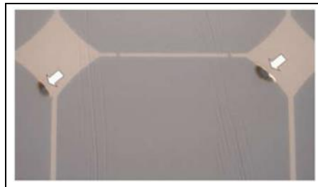
Figure II- 6. Modules présentant des points chauds sur les bords des coins supérieurs.
