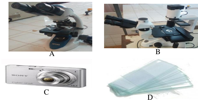
Figure 8 : Matériels d'identification et de comptage A : Microscope optique ; B : Microscope optique inversé ; C : Appareil photo ; D : Lame et Lamelle
