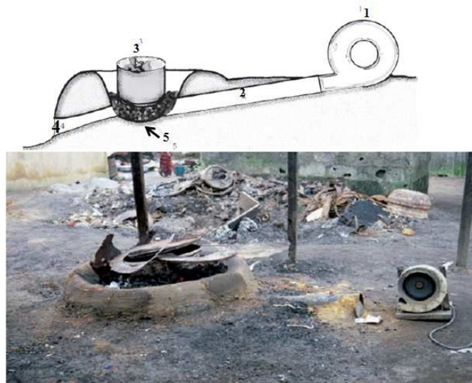
Figure II.2 : Four : aspect général et coupe transversale
