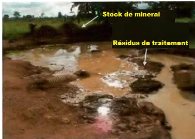
Figure 3: Accumulation des résidus de traitement du minerai dans un cours d'eau (Koffi et al. , 2014).
