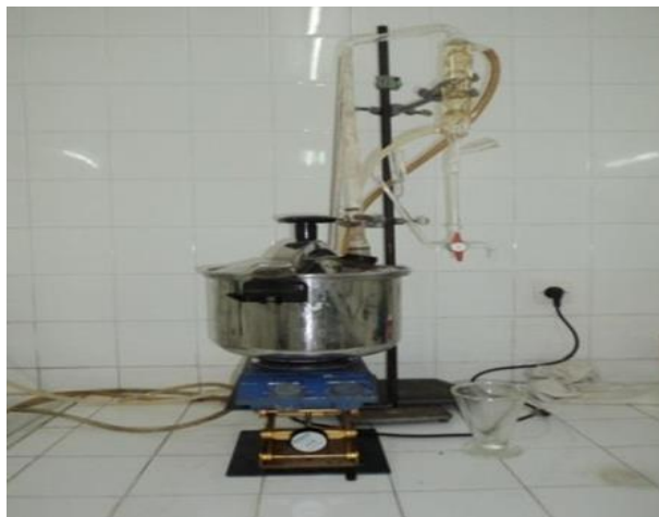
Figure 7 : Dispositif d'extraction avec appareil de type Clevenger (Oussou, 2009)
