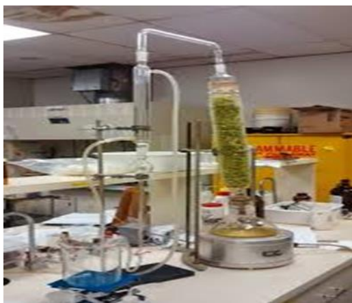
Figure 2 : Système d'extraction par entraînement à la vapeur d'eau saturée (Franchomme et al. , 1990).
