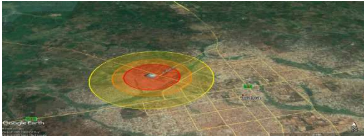
Figure 6 : Cartographie effets thermiques du BLEVE de citerne de GPL du centre emplisseur de la société STAR OIL à Daloa
