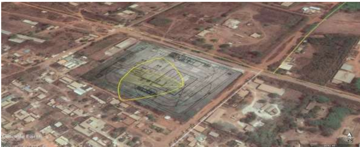
Figure 13 : Cartographie de l’UVCE au niveau de la pomperie GPL du centre emplisseur de la société STAR OIL à Daloa
