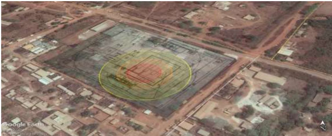
Figure 10 : Cartographie du feu torche au niveau de la pomperie GPL du centre emplisseur de la société STAR OIL à Daloa
