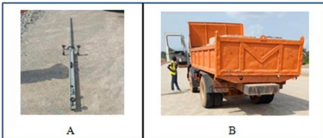
*A) Poutre de Benkelman ; B) Camion benne avec l'essieu arrière lesté à 13 tonnes*
