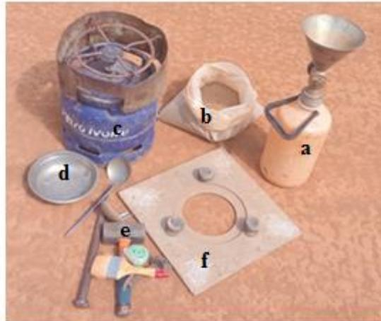
*a) Bombonne surmontée d'un cône ; b) Sable de mer de densité apparente connue ; c) Bouteille à gaz ; d) Tare ; e) Marteau ; f) Plaque.*
