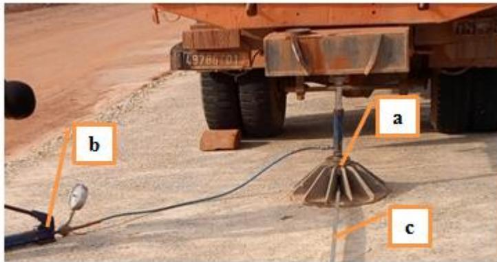
*a) plaque nervurée; b) système hydraulique de 160 kN avec manomètre de précision ; c) poutre de Benkelman*
