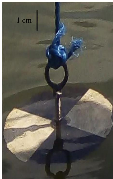
Figure 2: Disque de Secchi pour la mesure de la transparence de l'eau
