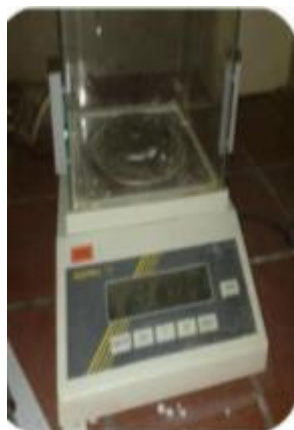
Figure 6: Appareil expérimental pour les mesures gravimétriques
