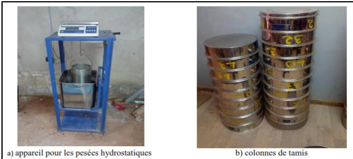
Figure 5. Dispositif pour la pesée hydrostatique et tamis pour l'analyse granulométrique.
