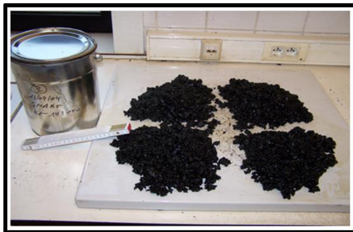
Figure 6. Opération de quartage d'un échantillon d'enrobés bitumineux
