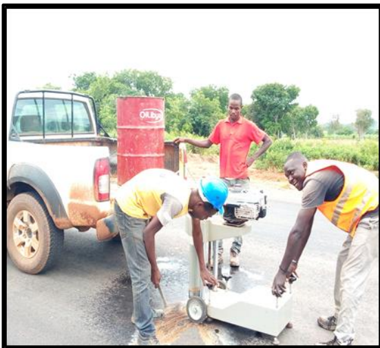
Figure 7: Essai de carottage et éprouvettes du BB compacté
