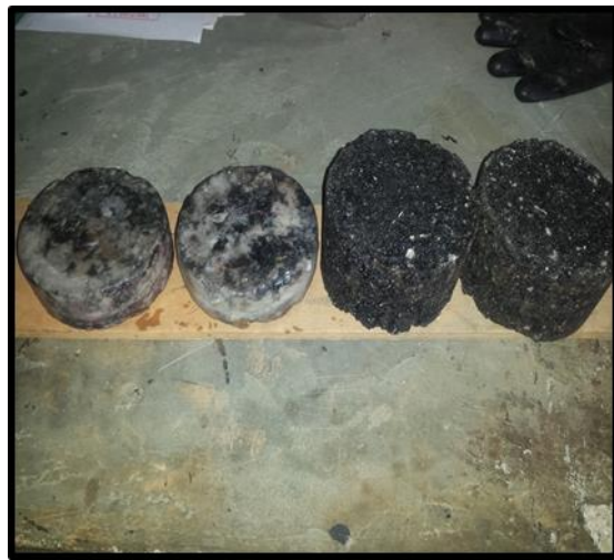
Figure 7: Essai de carottage et éprouvettes du BB compacté
