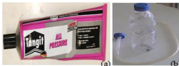
Figure 5 : Matériel de construction des réacteurs (a) : colle « tangit », (b) : bidon de 0,5 litre, un tube de stylo, un tuyau
