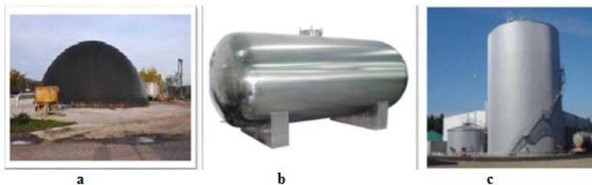
Figure 1 : a) Digesteurs-fosses couverte par une membrane étanche, b) Digesteur horizontal en acier, c) Digesteur vertical en acier.
