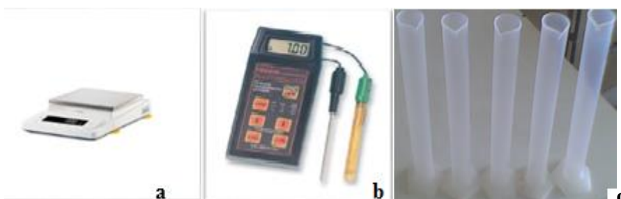
Figure 6 : Matériel de laboratoire (a) Balance analytique de marque SARTORIUS de sensibilité 10 mg, (b) pH-mètre de marque HANNA HI 8424, (c) burettes graduées de 100 ml
