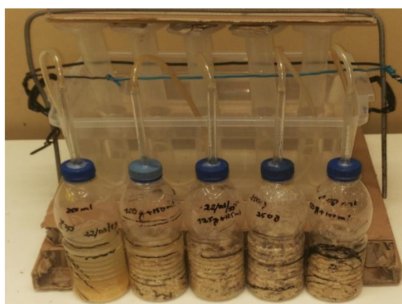
Figure 7 : Dispositif expérimental pour la production du biogaz, sa mesure et la détermination de sa teneur en méthane
