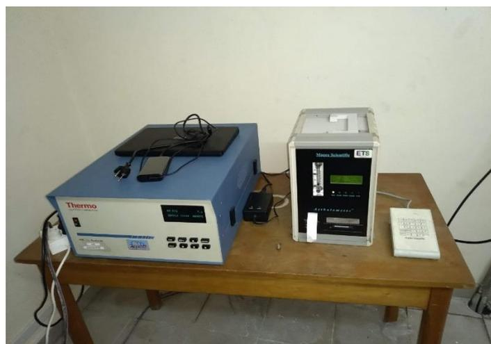
Figure 7 : Analyseur actif d'ozone Thermo Scientific modèle 49i
