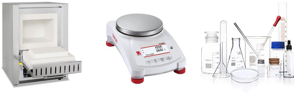
Figure 9 : Four à moufle (à gauche), Balance de précision (au centre) et Verrerie de laboratoire (à droite) pour l'analyse de l'acidité du cacao.
