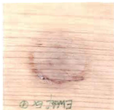
64-a : Etat en fin d'essai de l'éprouvette imprégné (EW-Asdef/Ex) : Cotation 0
