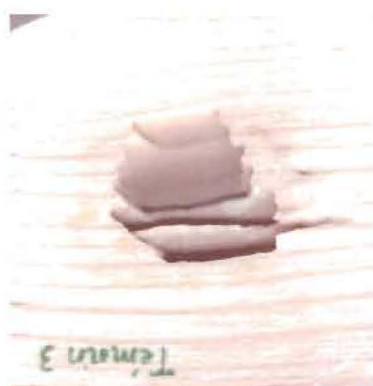
64-c : Etat en fin d'essai de l'éprouvette non imprégné (témoin) : Cotation 4
