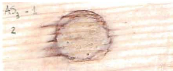
48-a : Etat de l'éprouvette imprégnée de H-As (Cotation 2)
