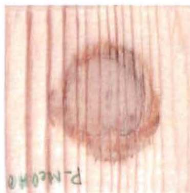
64-b : Etat en fin d'essai de l'éprouvette imprégné (P-MeOH) : Cotation 0
