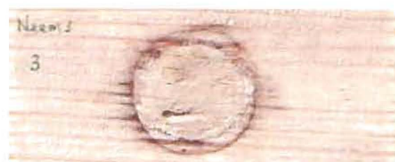
48-b : Etat de l'éprouvette imprégnée de H-Ai (Cotation 3)
