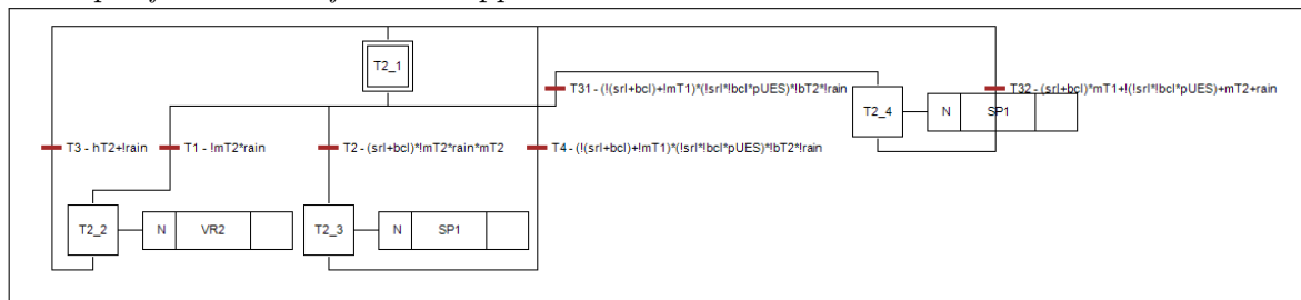
b-Spécification Grafset de l'approvisionnement en eau du réservoir T_2
