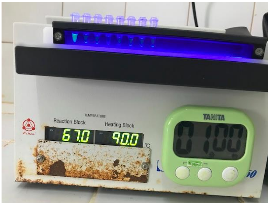
Figure 57 : Equipement pour Test TB LAMP (EINKEIN)
