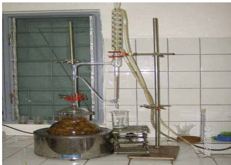
Figure n°12: Appareil d'hydrodistillation de type Clevenger au laboratoire de Phytochimie du Département de Biochimie de l'Université de Yaoundé I
