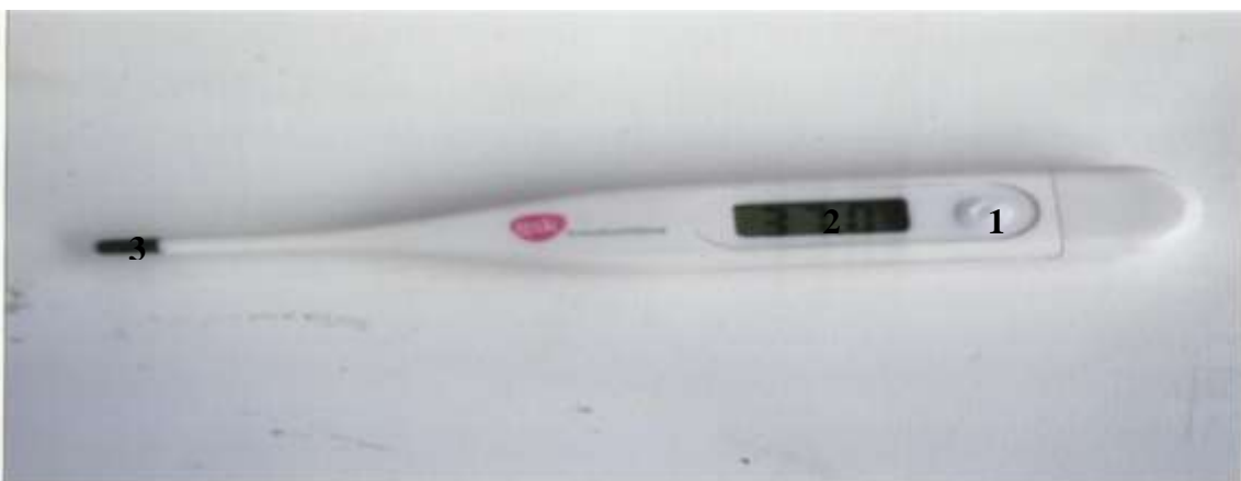
Figure 14 : Thermomètre digital ADDT01-A-GlaxoSmithKline (GSK) with automatic alarm, accuracy \pm 0,2 °C à 37 °C
