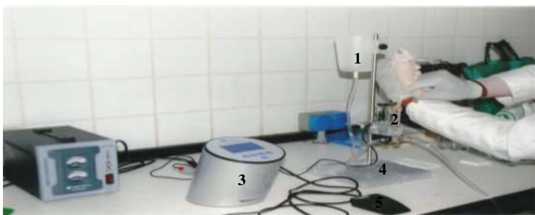
Figure 7 : Pléthysmomètre électrique (model 37140 UGO BASILE, Italie) (Photo prise par Minoué Kuum marc germain en Juin 2014, Echelle : 1/1).
