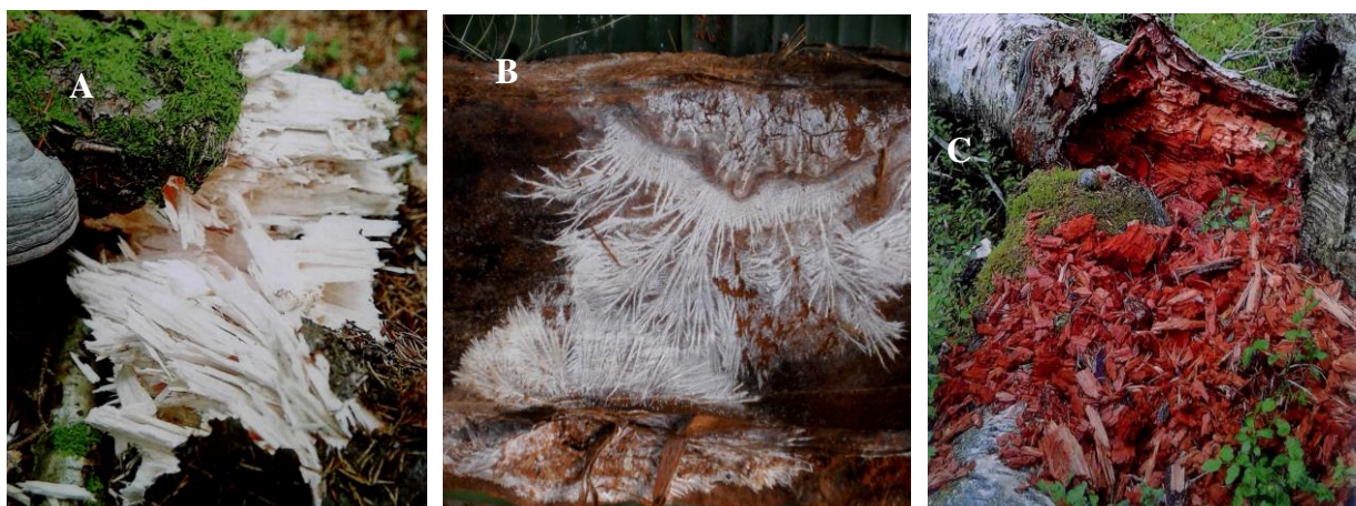
Fig. 6. Différents types de pourriture causée par les champignons lignivores sur le bois, A/B. Pourriture blanche, C. Pourriture brune (Photo Mossebo, Nsimeyong Cameroun, 2012 ; 2019).
