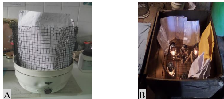
Fig. 28. Processus de séchage des échantillons à température convenable. A. séchoir électrique Dörrex, B. séchoir artisanal confectionné et utilisant les lampes à pétrole.
