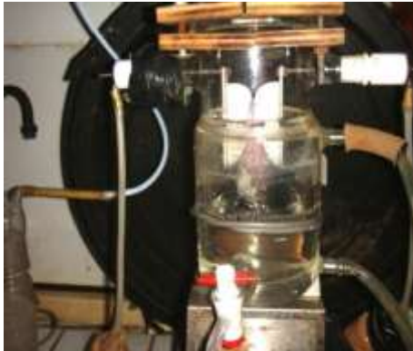
Vue du réacteur en absence de la décharge
