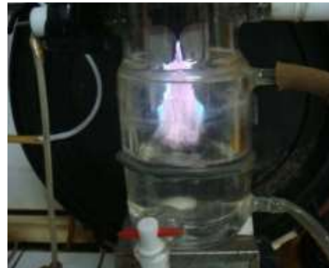
Vue du réacteur en présence de la décharge (décharge continue)
