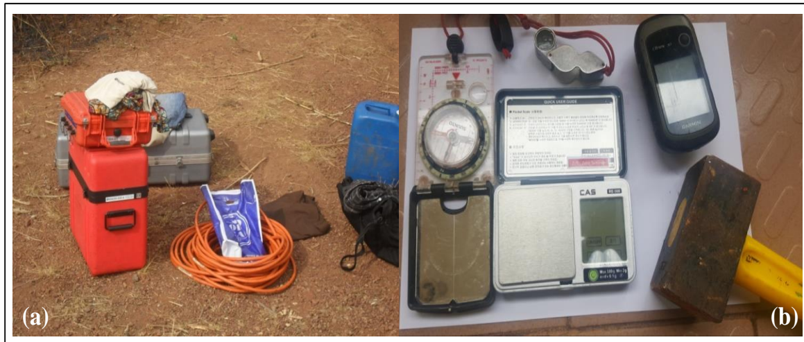
Figure 16: une vue de l'équipement utilisé dans le cadre de la présente étude. L'équipement Stratagem (a) et les principaux instruments de prospection géologique (b).
