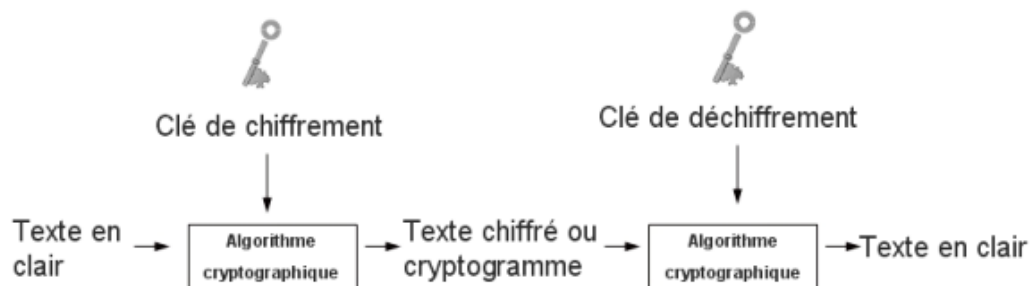
Figure 2 – Procédure de base pour le cryptage à clef secrète. Figure tirée de Dumont (2009)
