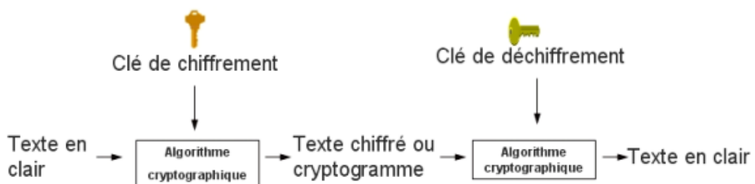
Figure 8 – Procédure de base du cryptage à clef publique. Figure tirée de Dumont (2009)
