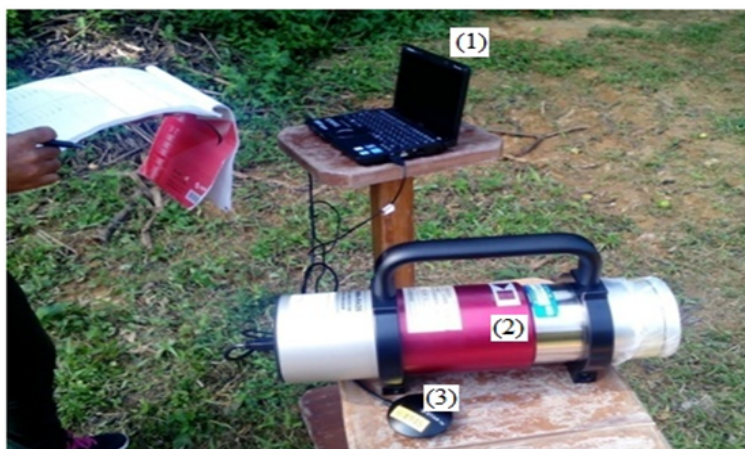
Figure 2.3 – Chaîne de montage de la spectrométrie gamma in-situ . Il s'agit : en (1) un ordinateur portable contenant le logiciel d'analyse ; en (2) le spectromètre à scintillation NaI(Tl) 3 \times 3 pouces avec le préamplificateur et l'amplificateur ; en (3) un GPS pour mesurer les coordonnées géographiques du point de mesure.
