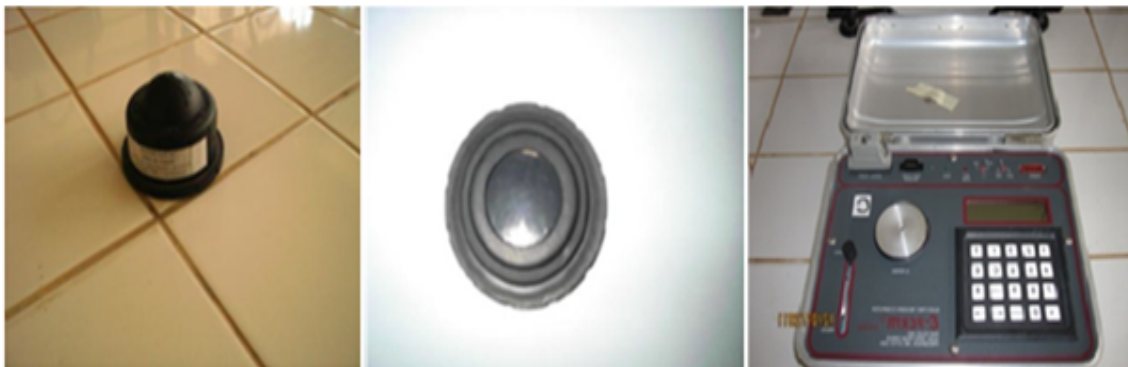
Figure 2.11 – Couverture du dosimètre (à gauche) ; le dosimètre E-perm (au milieu) ; le lecteur de dosimètre (à droite)
