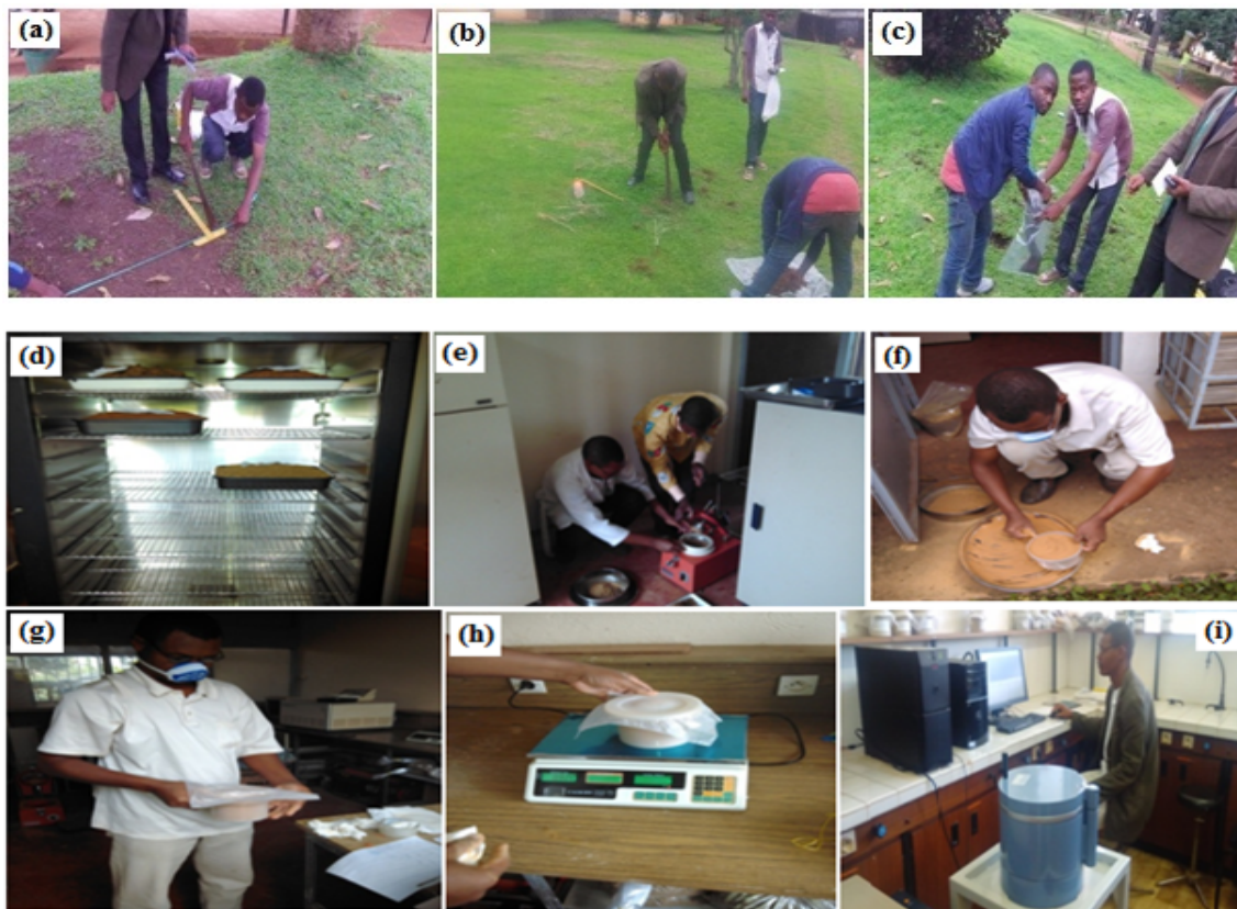
Figure 2.5 – Échantillonnage sur le terrain, préparation, conditionnement et mesure de la radioactivité naturelle par spectrométrie \gamma dans les échantillons de sol au laboratoire de la Section des Techniques Nucléaires de l'IRGM (Nkolbisson-Yaoundé)
