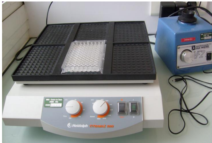
Figure 31. Agitateur Heidolph Titrimax
