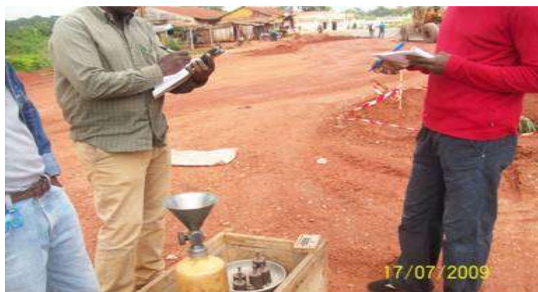
Figure 22. Calcul de compacité sur la couche de base du PK 54+680 à côté de cône à sable sur la route Abong-Mbang-Bonis (ville de Doumé)
