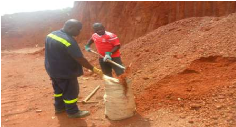
Figure 12 . Prélèvement de sols latéritiques nodulaires dans la zone de Nganké (Est Cameroun)
