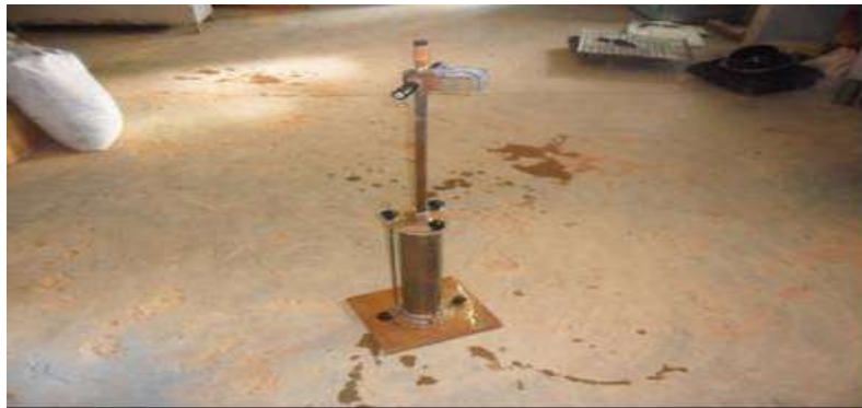
Figure 21. Densitomètre à membrane étalonné et prêt à être utilisé
