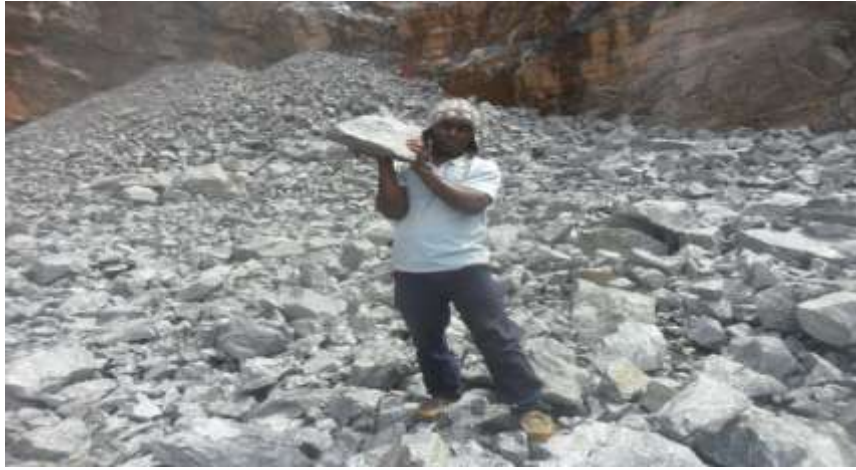
Figure 10. Prélèvement des moellons pour essais pétrologique dans la zone de Bent à Doumé (Est Cameroun)
