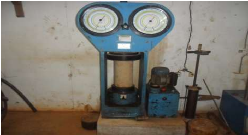
Figure 26: Appareil de presse à béton
