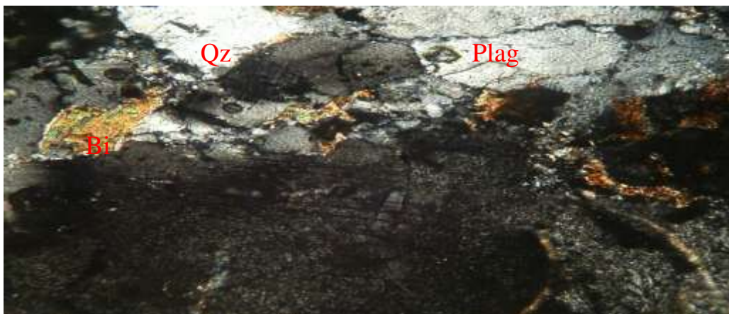
Figure 32 : Une vue de l'organisation microscopique de migmatite de Batouri en LPA, Qz : Quartz, Plag : Plagioclases, Bi : Biotite, Mc : Microcline
