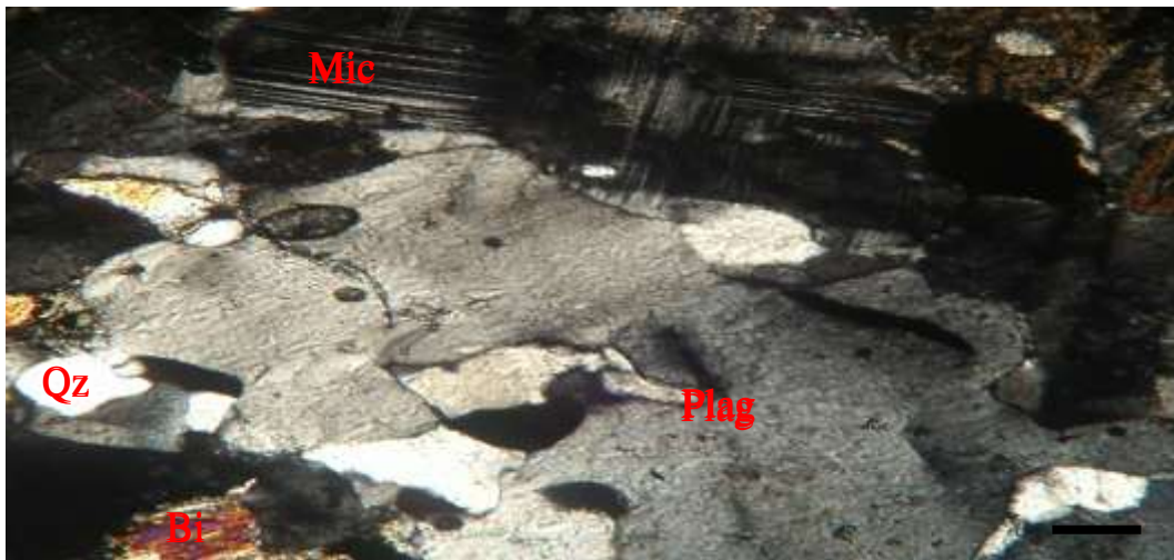
Figure 31 : Une vue de l'organisation microscopique de granite de Bertoua en LPA, Qz : Quartz, Plag : Plagioclases, Bi : Biotite, Mic : Microcline
