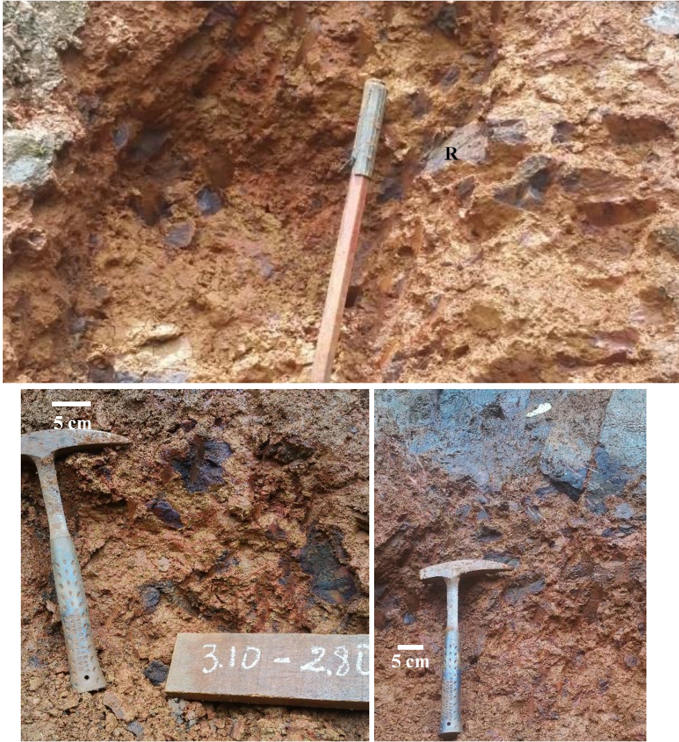
Figure 62 : Aspect macroscopique de l'horizon bariolé vu in situ. R : résidus de saprolite grossière.
