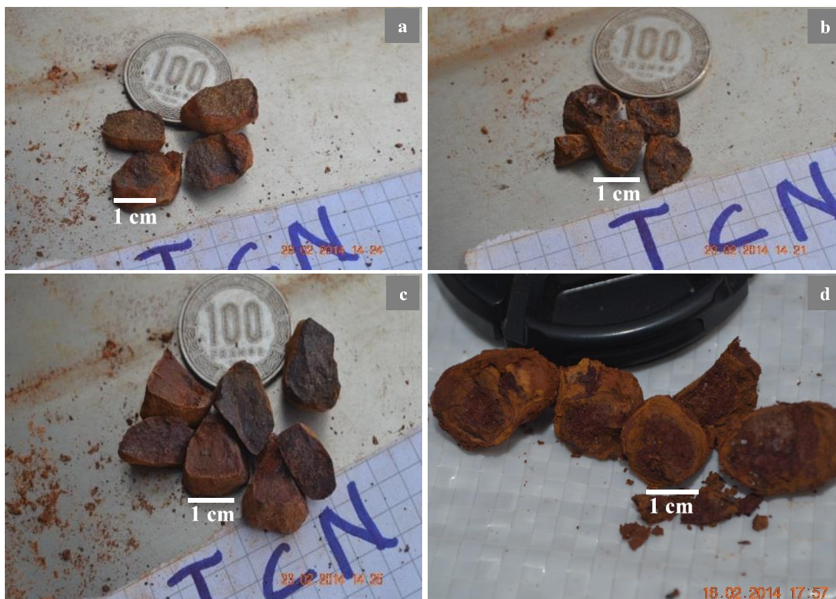
Figure 52 : Formes nodulaires de l'ensemble ferrugineux. A , gravillons ferrugineux à structure lithique fruste ; B , nodules poreux à fine patine goethitique ; C , nodules à structure massive sans patine ; D , pseudopisolithe à cortex goethitique et cœur hématitique avec inclusion de fins grains de quartz.
