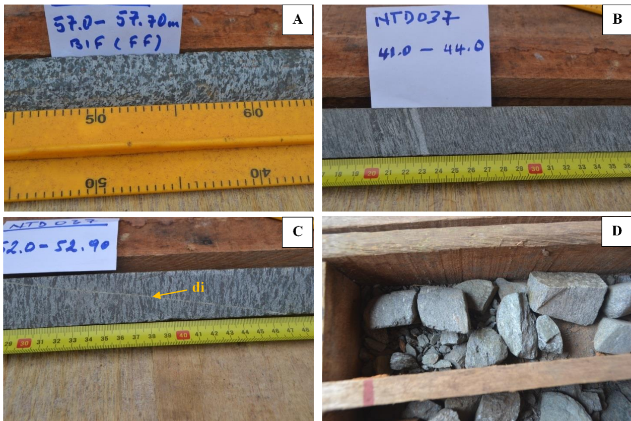
Figure 35 : Différents faciès macroscopiques du GIF d'Anyouzok. A : GIF à structure granoblastique ; B : GIF à plan de foliation nette ; C : GIF à plan de foliation fruste (di : diaclase remplie de calcite) ; D : GIF mylonitique.
