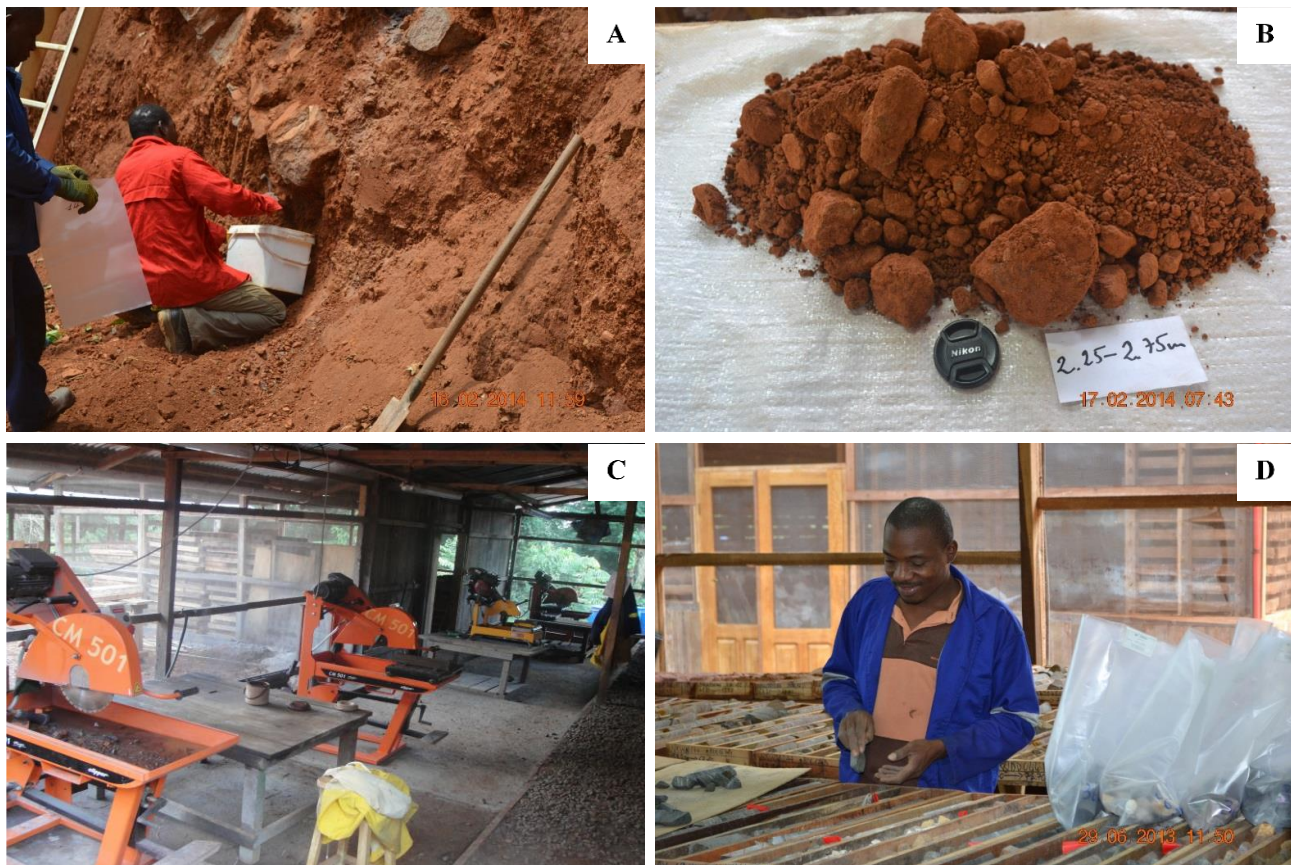
Figure 30 : Prélèvement des échantillons perturbés sur le terrain. A : échantillonnage au marteau sur talus ; B : échantillon perturbé non quarté ; C : atelier présentant des scies électriques à disque diamanté pour le sciage des carottes ; D : échantillonnage sur carotte de sondage.
