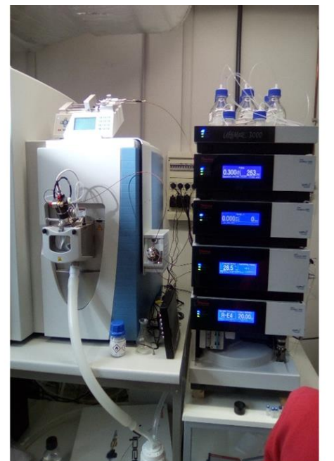
Figure 34: Appareil pour la Chromatographie en Phase Liquide à Haute Pression (CLHP) couplée à la spectrométrie de masse
