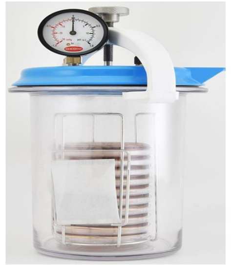
Figure 31: Incubation des boîtes de pétries de culture de H. pylori avec un générateur d'atmosphère micro aérobie Gaspack
