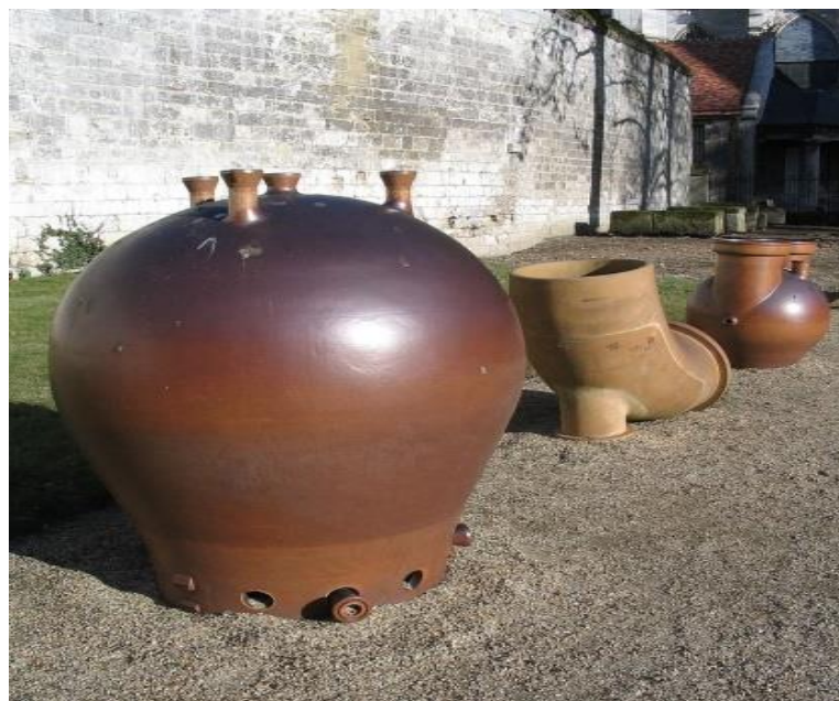
Figure 13 : tuyaux de canalisation en grès pour l'industrie chimique
