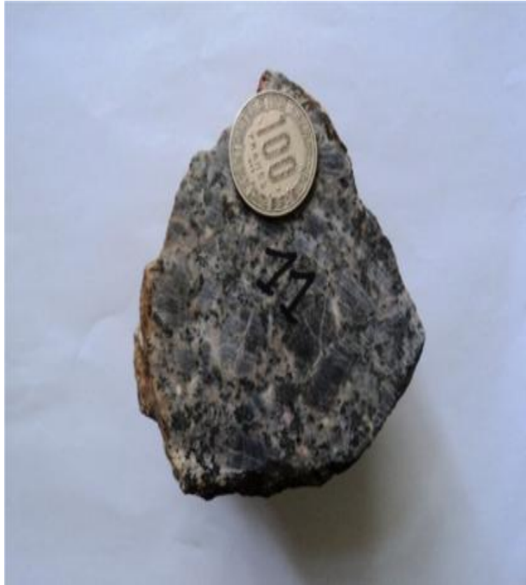
Figure 21 : aspect physique de l'échantillon de syénite de Linté.
