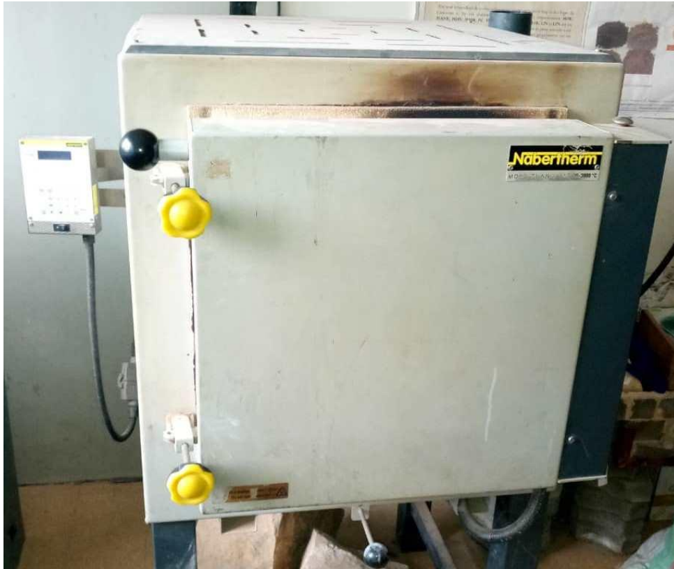
Figure 24 : image du four électrique programmable de marque Nabertherm (RHF 1500).
