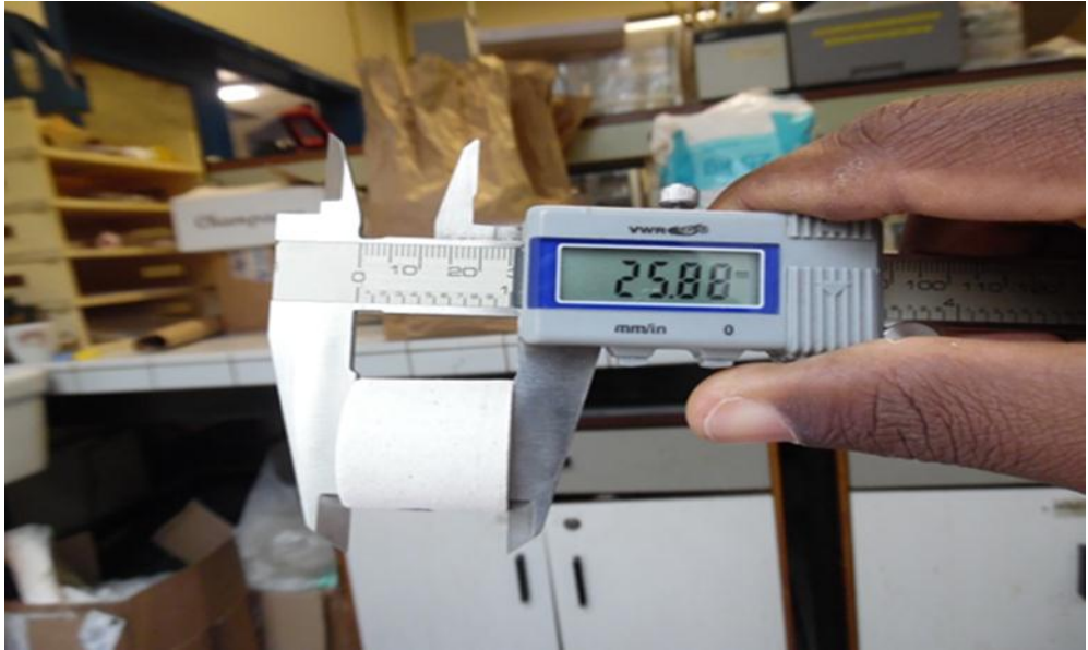
Figure 73: Mesure du retrait à l'aide d'un pied à coulisse électronique.
