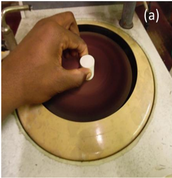
Figure 77: Polissage (a) et observation au microscope optique (b) de la surface d'un échantillon.
