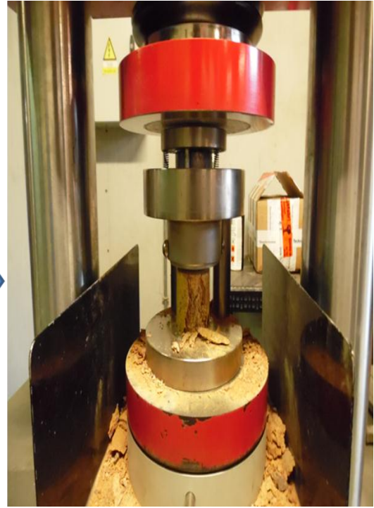
Figure 75: Essai d'écrasement ou de compression à l'aide d'une presse électrique Toniversal.
