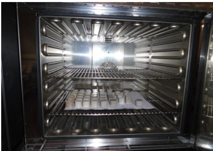
Figure 23: Etuvage à 110 °C des briques réfractaires.
