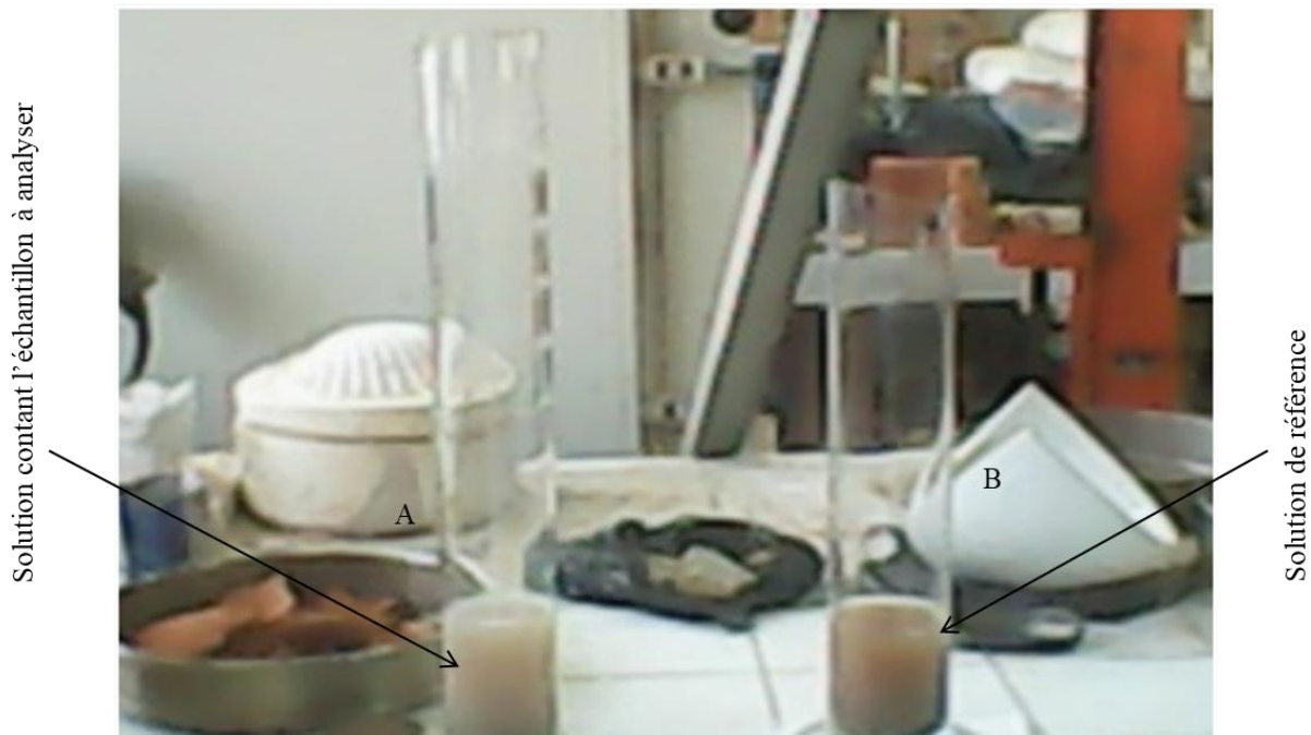
Figure 15: Mesure par sédimentométrie.
