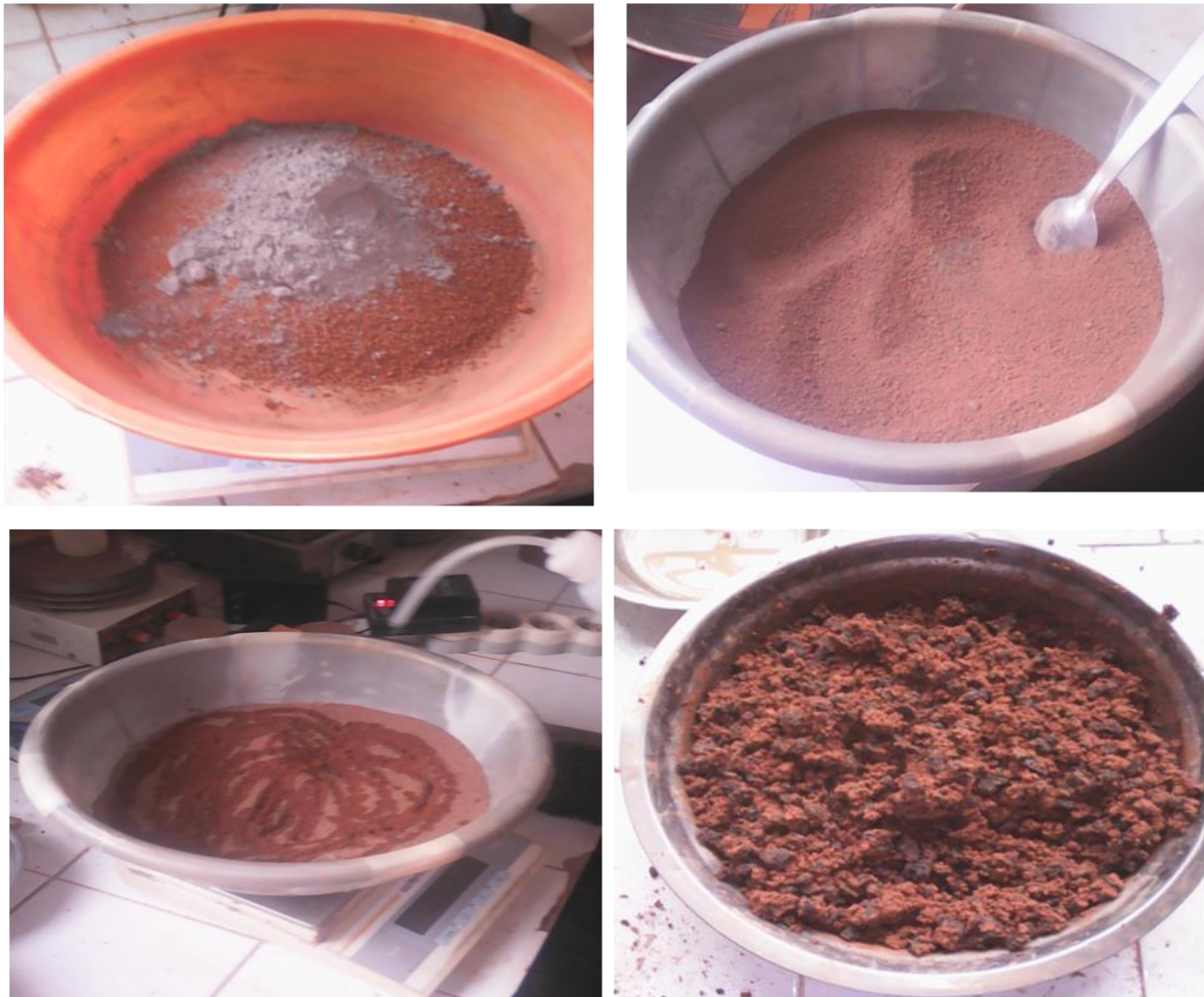
Figure 2.27: Différentes étapes de confection de certains échantillons.
