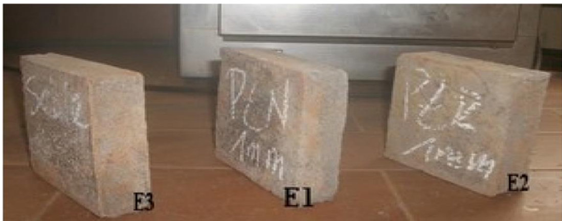
Figure 2.37: Echantillon de parpaing de sable (à gauche), de pouzzolane noire (au centre) et de pouzzolane rouge (à droite).
