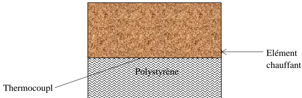
Figure 2.6: Schéma de principe de la méthode du plan chaud avec un échantillon semi-infini.
