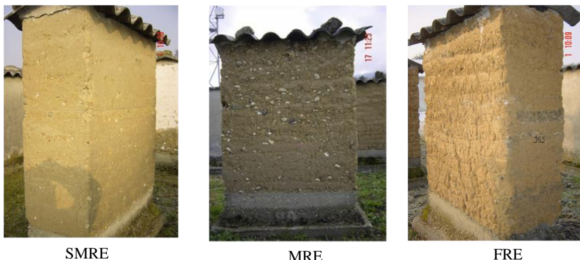
Figure 1.20: Différents murs en terre exposés 20 ans durant aux conditions climatiques de France (Bui et al., 2009).
