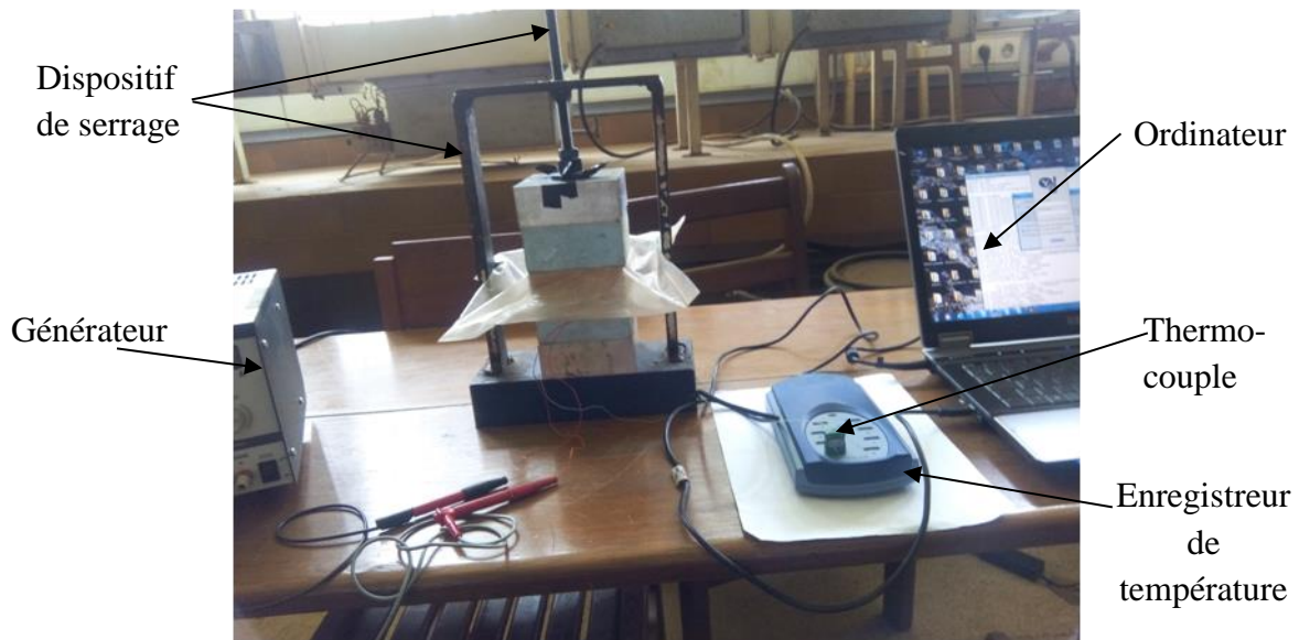
Figure 2.14: Appareillage de caractérisation thermophysique utilisé.
