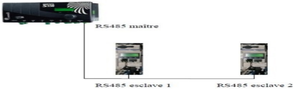
Figure 20: principe de fonctionnement du bus modBus
