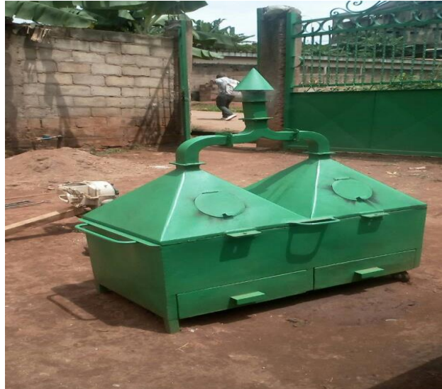
Fig.39. Vue d'ensemble du Mini-incinérateur artisanal.
