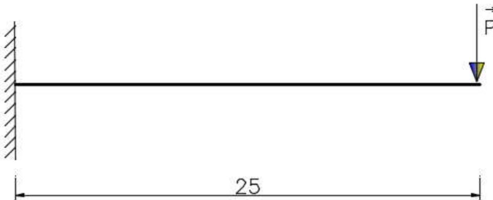
Figure 34 Modélisation des charges appliquées à la vis
