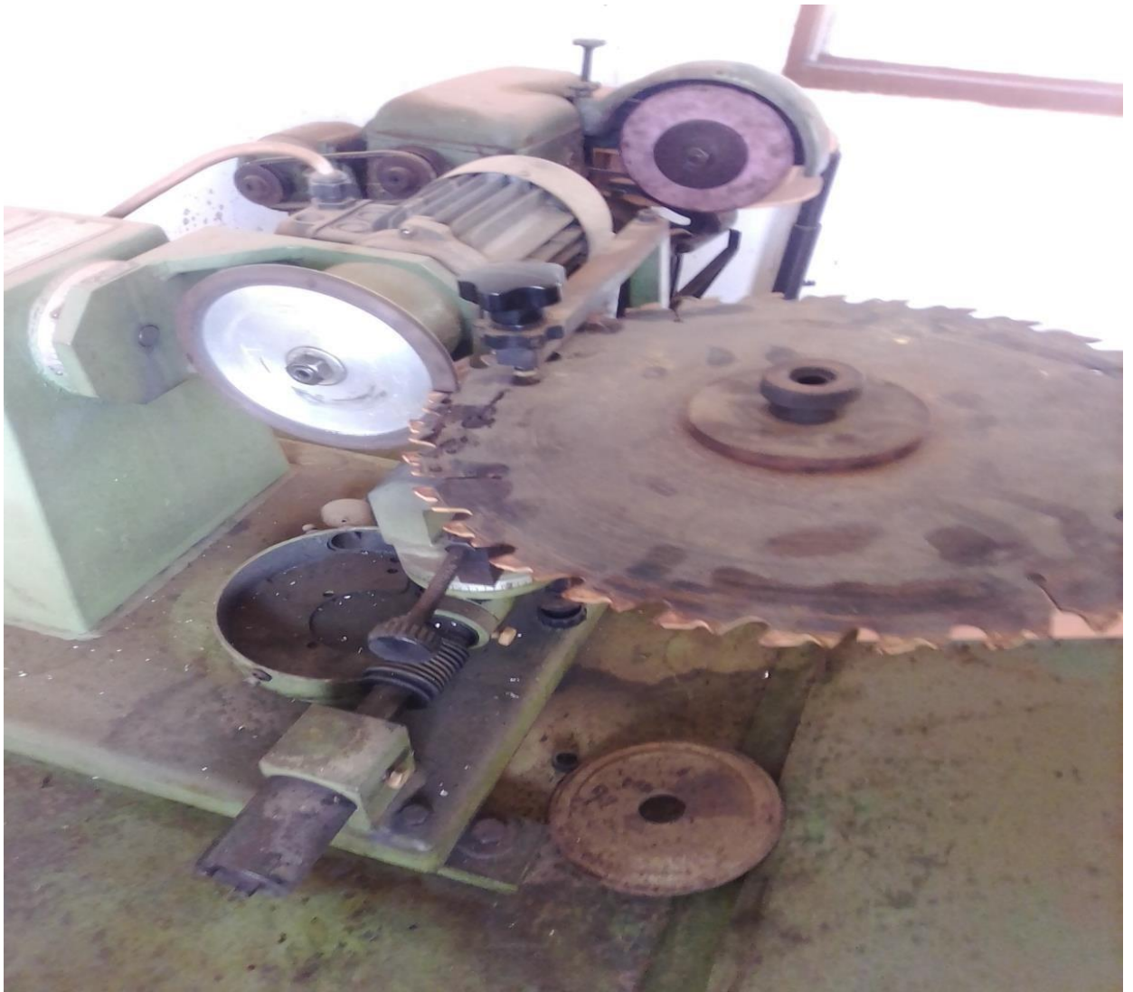
Annexe 5. Opération d'affutage d'une lame au carbure à la meule diamantée.
