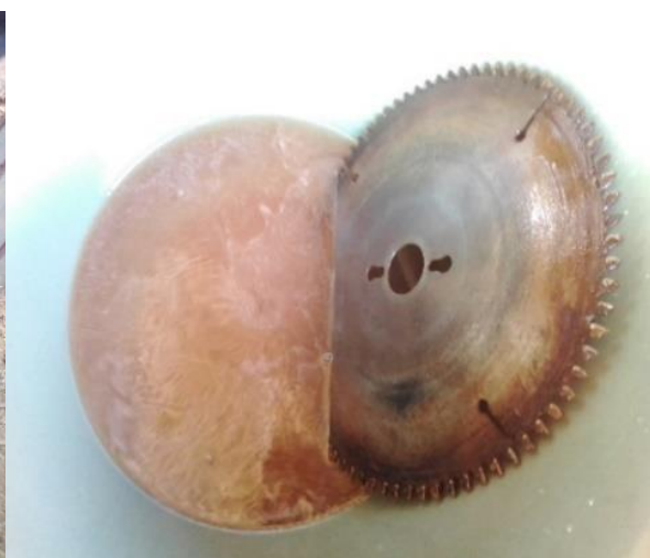
(Photo.3-19) Entretien par enlèvement de là dans un la résine de bois sur le corps de la lame propre.
