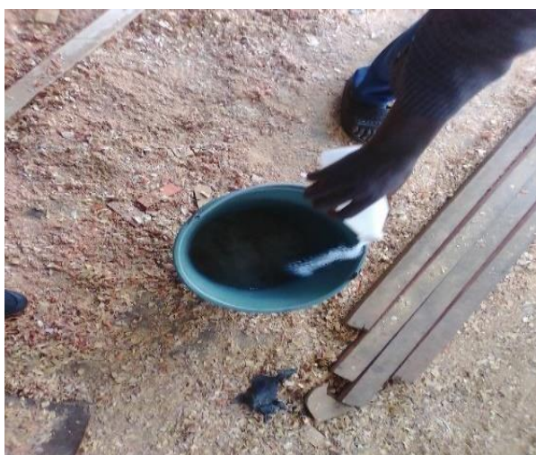
(Photo.3-18) Soude caustique versée récipient contenant de l'eau
