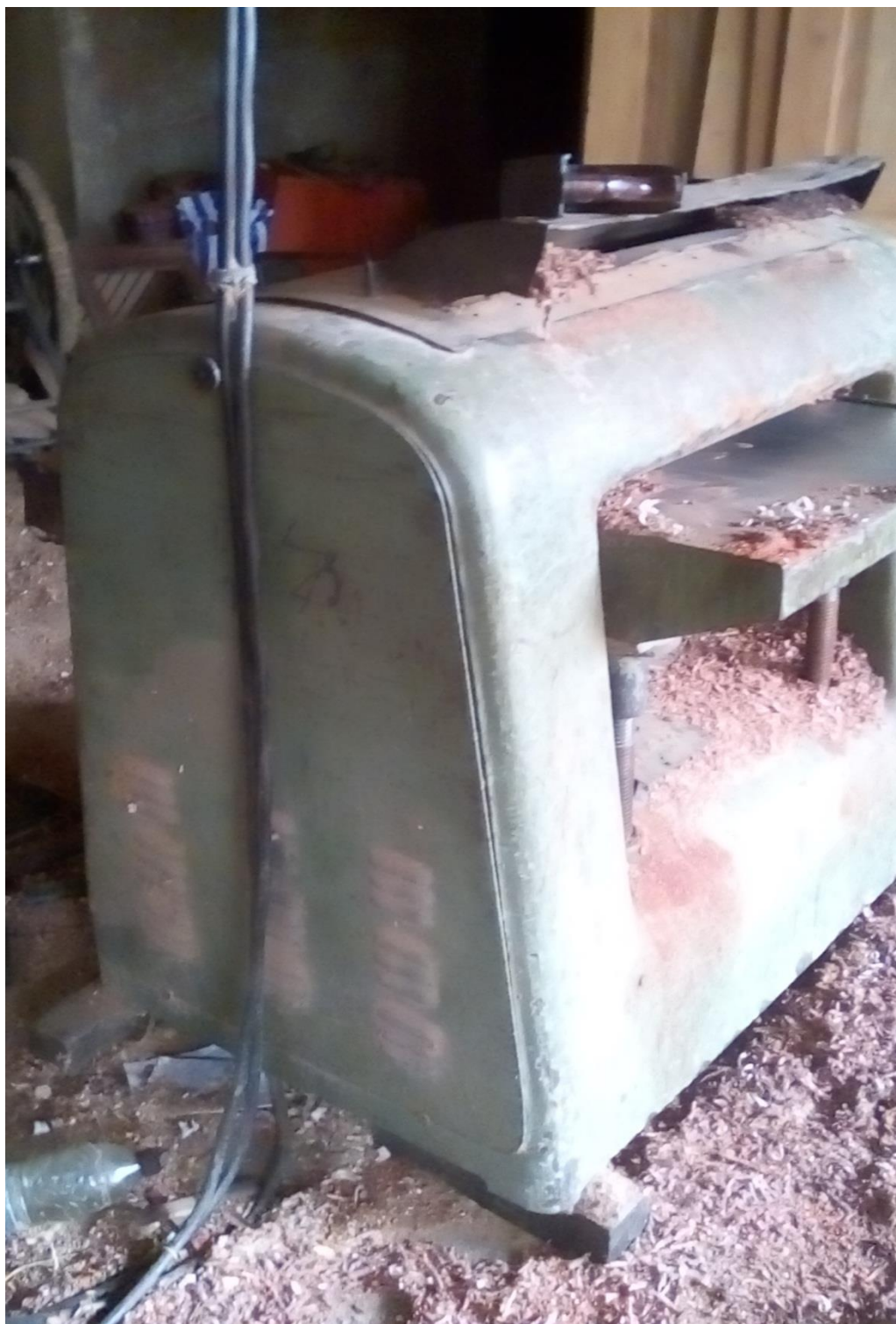
Figure d : la Raboteuse utilisée pour la mise en épaisseur du bois
