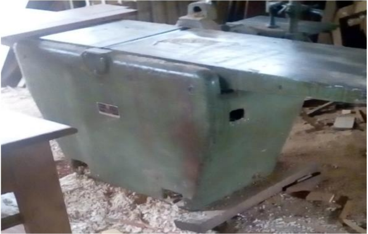
Figure c : la Dégauchisseuse utilisée pour le corroyage du bois
