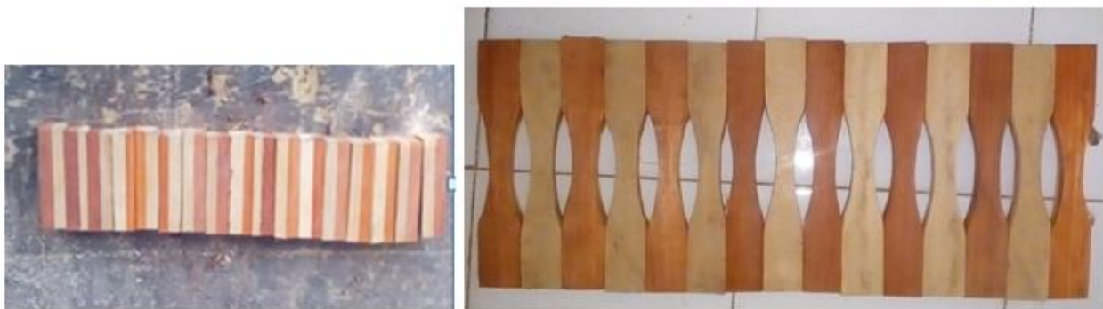
Figure 2.3 : Eprouvettes de traction axiale (à droite) et Eprouvettes de compression axiale (à gauche)
