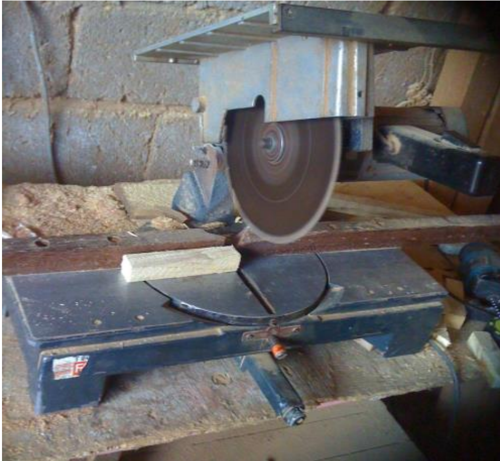
Figure g : la Scie circulaire mobile utilisée pour le tronçonnage des éprouvettes
