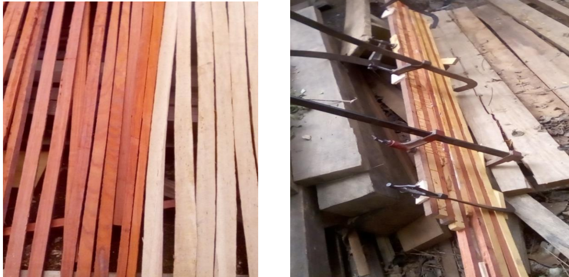
Figure 2.1 : Bois lamellé panaché (à gauche) et Bois lamellé collé serré (à droite)
