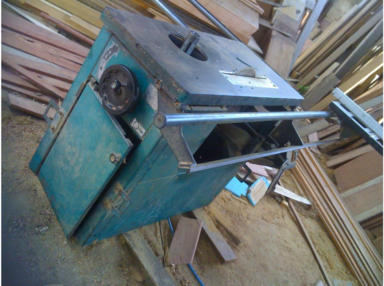
Figure f : la Scie radiale utilisée pour l'usinage du BLCC
