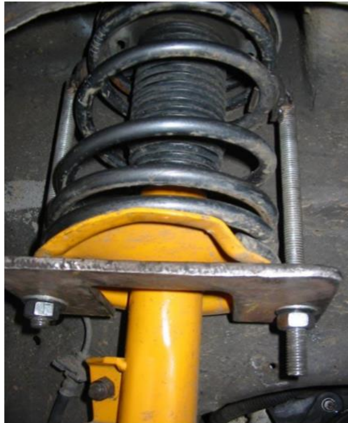
Figure 15:cas pratique d'un compresseur a deux tiges de compression
