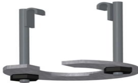
Figure 13 : Compresseur de ressort à deux tiges de compression [10]
