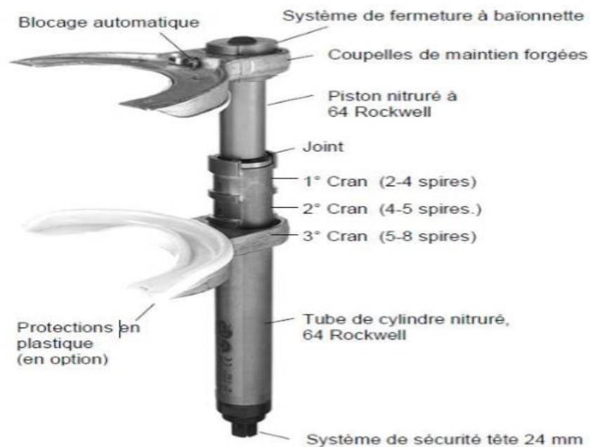
Figure 18: compresseur de ressort télescopique universel [11]
