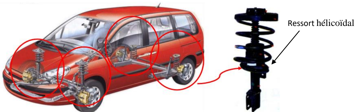
Figure 7:localisation du ressort hélicoïdal sur une voiture [1]
