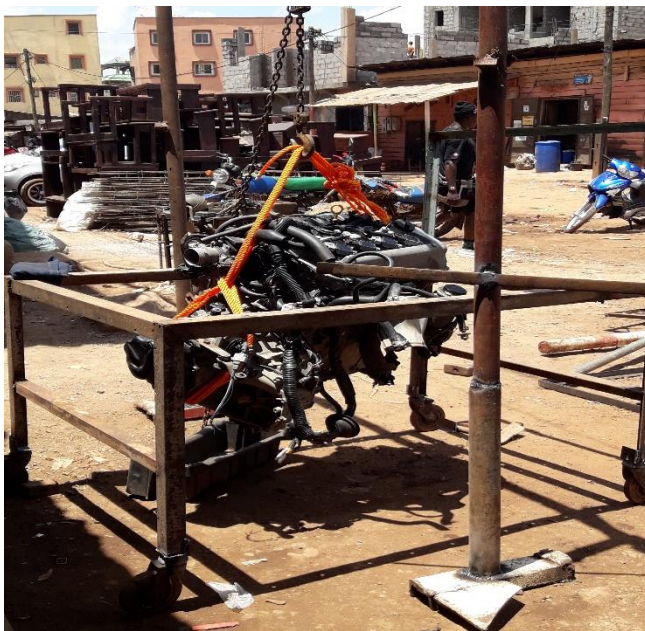
Figure Annexe 3 moteur sur bâti en cours de montage
