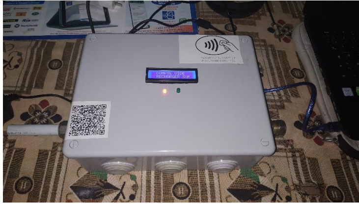
Figure III-2 : Compteur lorsque le compte est vide en volume d'eau
