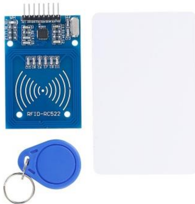
Figure II-13 : Module RFID RC522 avec Carte et Bracelet Mifare Classic 1k [18]
