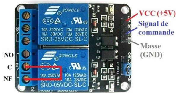
Figure II-23 : Relai - Contact Normalement Fermé
