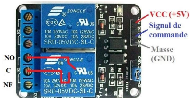
Figure II-22 : Relai - Contact Normalement Ouvert
