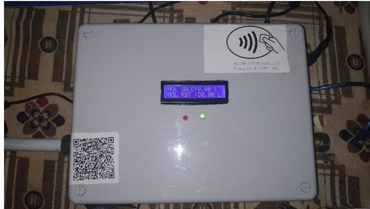
Figure III-5 : Le compteur en fonctionnement normal
