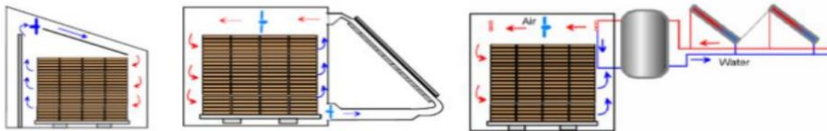
Figure 11: Séchoir avec capteur intégré (a), Séchoir solaire avec capteur semi intégré (b) et Séchoir solaire avec stockage (c) ( Sanchew, 2008)
