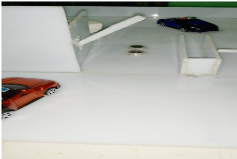
Figure III-48 : ouverture automatique de la barrière en cas de sortie d'un véhicule.
