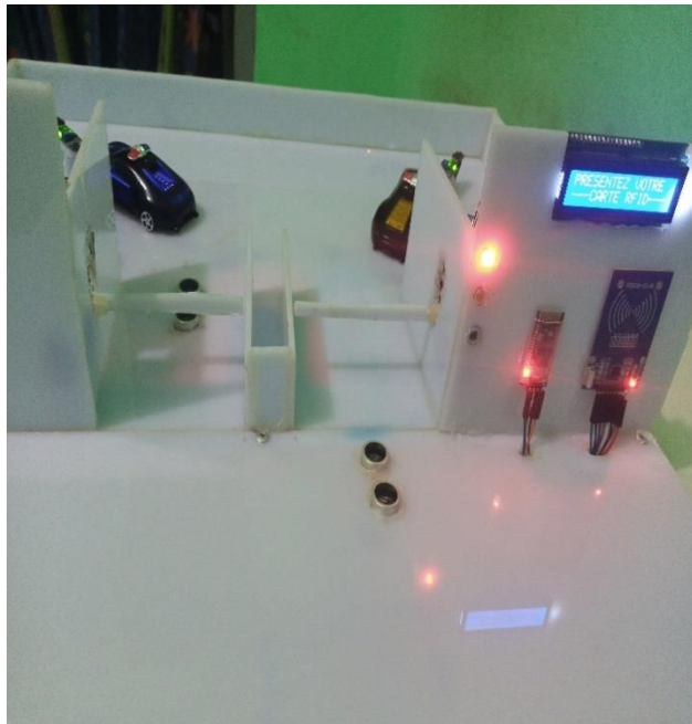
Figure III-49 : affichage de l'état d'occupation des places sur l'écran LCD.
