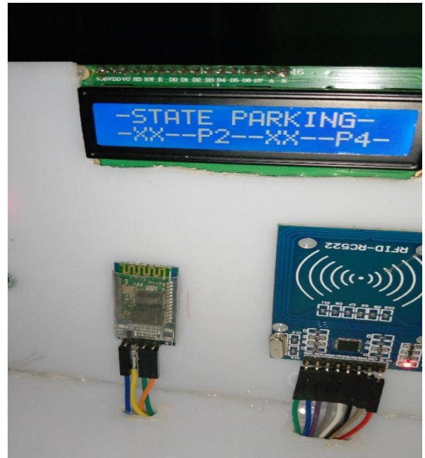
Figure III-49 : affichage de l'état d'occupation des places sur l'écran LCD.
