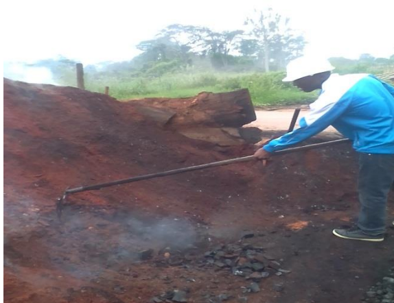
Figure : Défournement de la meule
