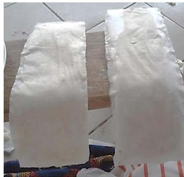
*Figure 35: Cellulose compactée et dimensionnée*
