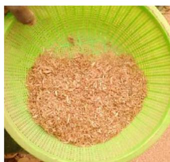
(a) Obtention de la sciure et triage      (b) Tamisage et obtention des fibres
