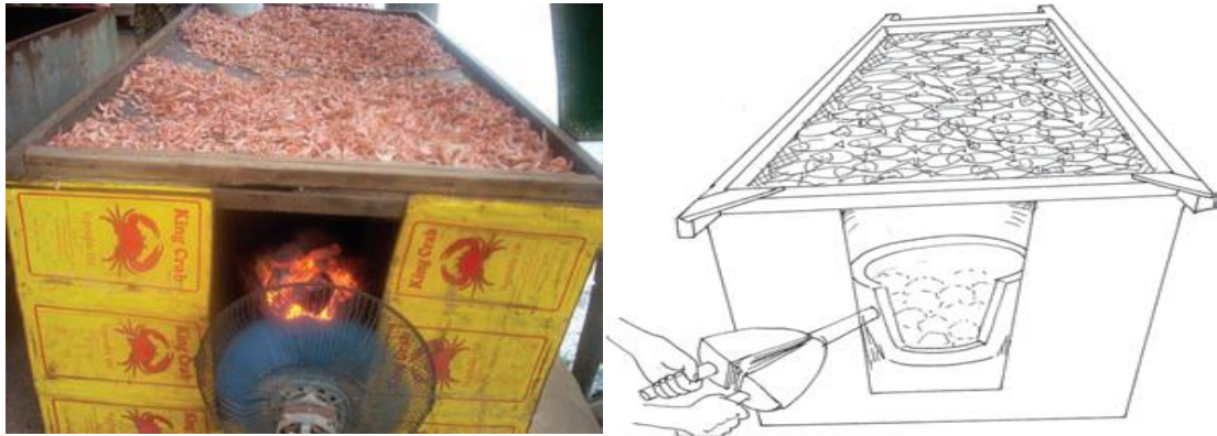
Figure II-5 Séchoir artisanal (à charbon avec soufflet) [25].
