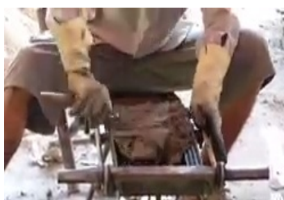
Figure II.1 : Moule métallique pour tuiles en béton
