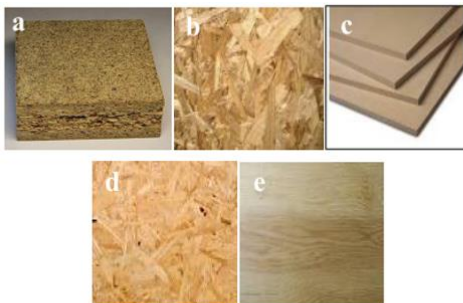
Figure I-14: panneaux de bois : (a) panneaux de particules, (b) panneaux de copeaux, (c) panneaux MDF, (d) panneaux OSB, (e) contreplaqué
