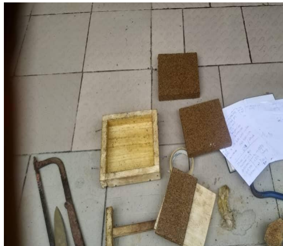
Figure II-9: Démoulage du panneau
