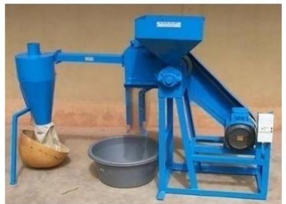
Figure 19 : Décortiqueuse « GMBF » de type Engelberg avec moteur électrique
